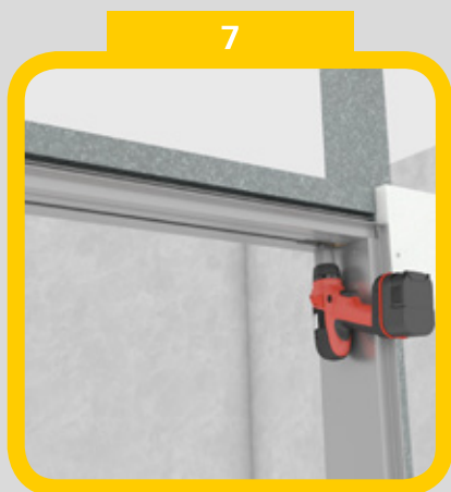
Pokud omítník nelícuje s pomocnou SDK deskou, povolte hliníkovou kolejnici
