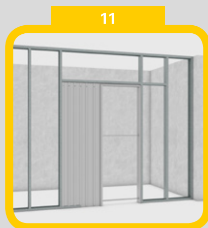
Usazené pouzdro v SDK konstrukci
