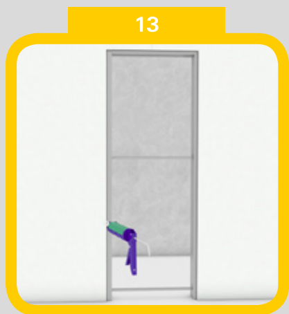
13 Zatmelení spáry mezi SDK a omítkou pouzdra vysoce pružným tmelem
