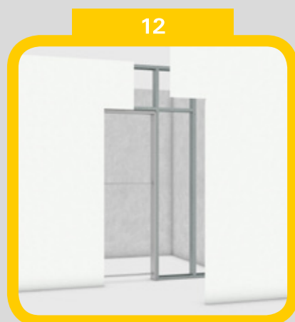
Opláštění pouzdra - SDK desku je nutné ukotvit do první vlny bočnice stavebního pouzdra v místě průchodu
