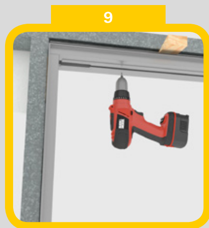
Opětovným utahnutím kolejnice zafixujte správnou polohu horních omítníků
