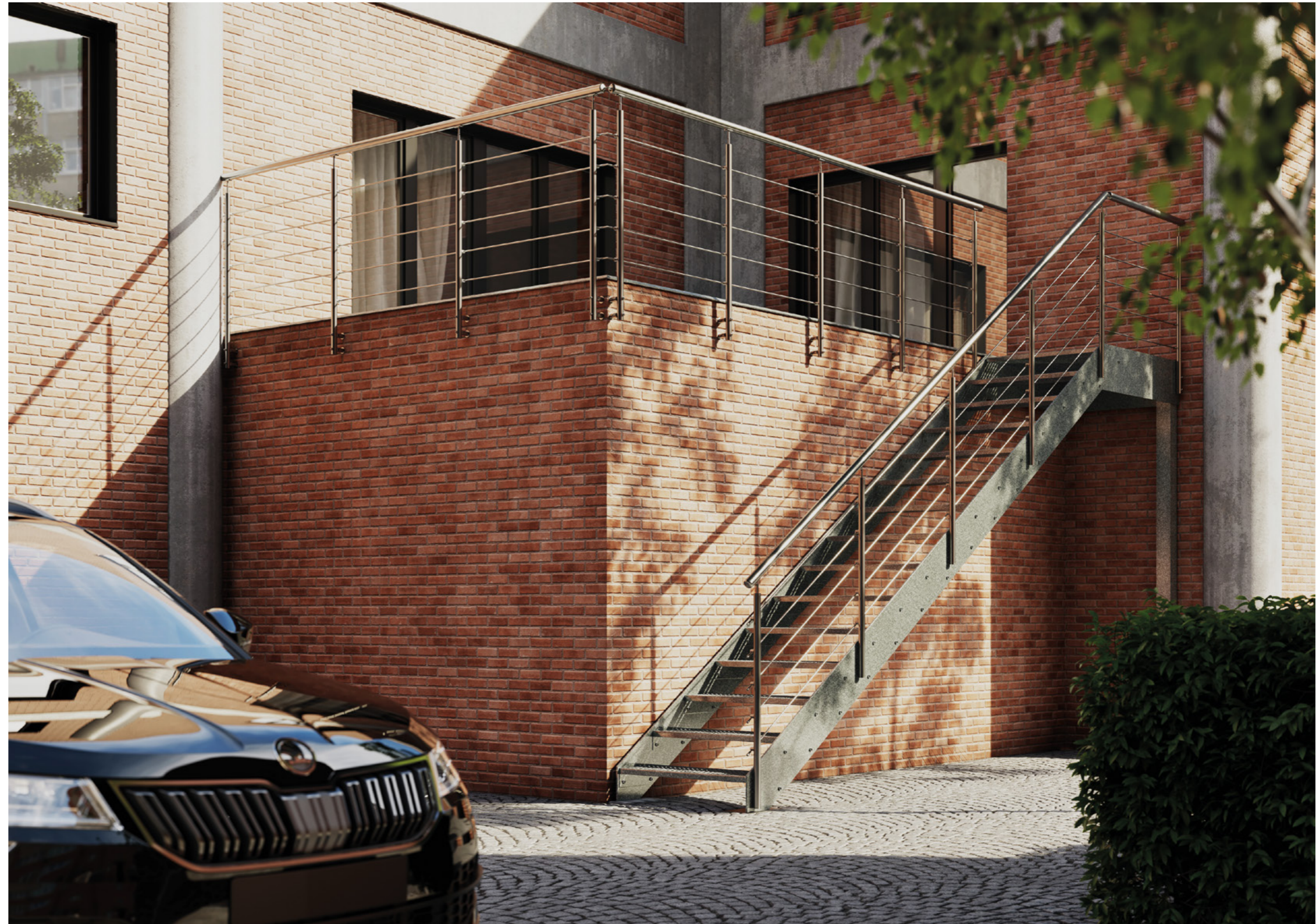
Exteriérové schodiště s žárově zinkovanou konstrukcí a stupni z pororoštu. Nášlapy lze dodat v provedení tahokov nebo bangkirai. Zábradlí s podélnou výplní z kartáčované nerezí.
